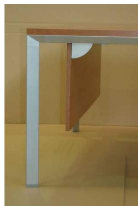
**ESTRUCTURA:** Faldon laminado, fabricado en tablero de 19mm de espesor, canteado en PVC de espesor 2 mm y aristas redondeadas con radio 2mm.
